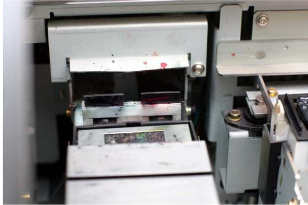
Usando de nuevo un bastoncillo de limpieza o una gamuza especial para solventes con unas gotas de líquido limpiador limpiaremos todos los restos de tinta seca de la parte delantera y posterior del wiper.
