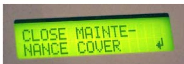
**Colocaremos otra vez la tapa del área de mantenimiento izquierda en su emplazamiento y pulsaremos la tecla *ENTER*, tras lo que la impresora se apagará y habremos completado el proceso de limpieza.**
